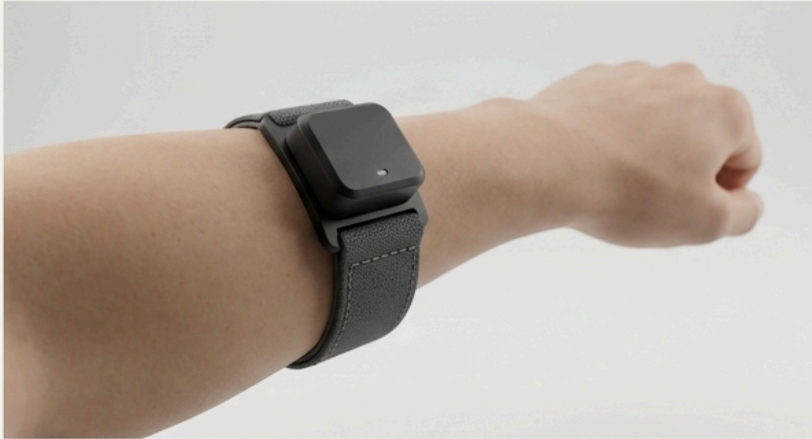
Système portable à base d'IMU pour la mesure cinématique en continu.
